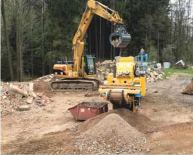
Die mobile Brecheranlage für Beton und Bauschuttrecycling.
